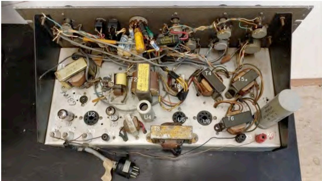
Abb. 35 Grundplatte Oberseite (Beschriftung: T=Transformator, U=Röhre, X=externer Netzteil).
