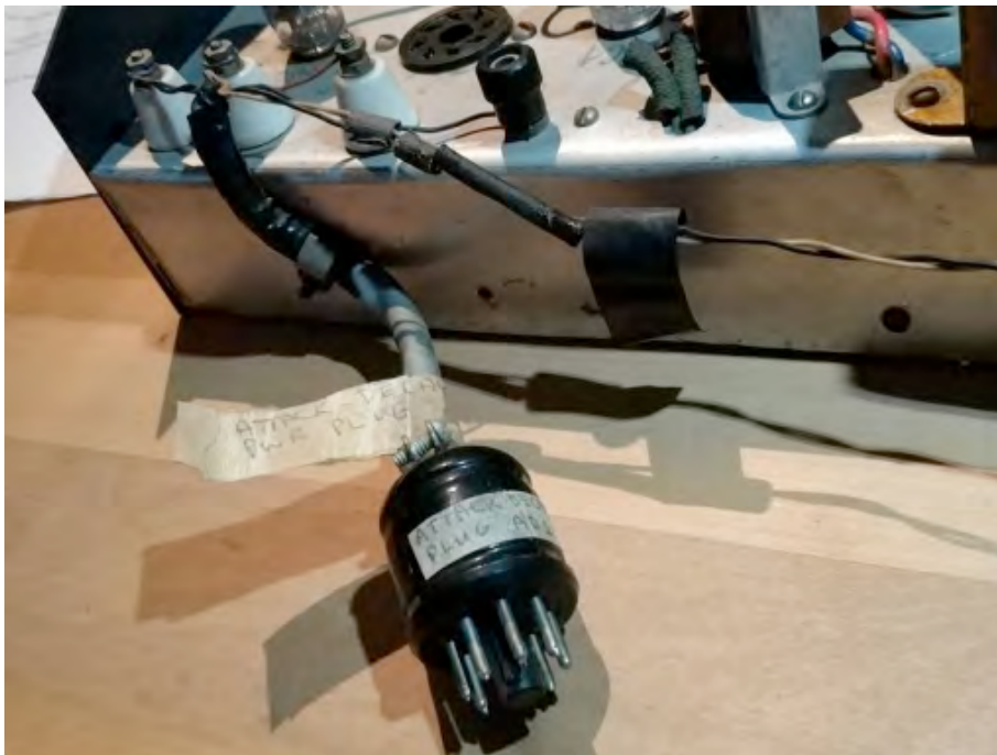
Abb. 36 Oktalstecker zum Netzteil. Beschriftung: „ATTACK-DECAY PWR PLUG“
